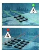
Знак "Указатель рейда" ("Рейдовый знак") определяет верхнюю и нижнюю границы рейда. Имеет вид створа: на переднем знаке створа треугольник основанием вниз, на заднем – вверх. Количество линий судов – пыжей! (*передний знак*).
